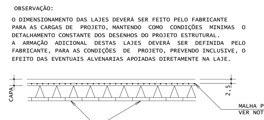
DETALHE TÍPICO DAS LAJES PRE-LAJE (PAINEL) ESCALA: 1:40
